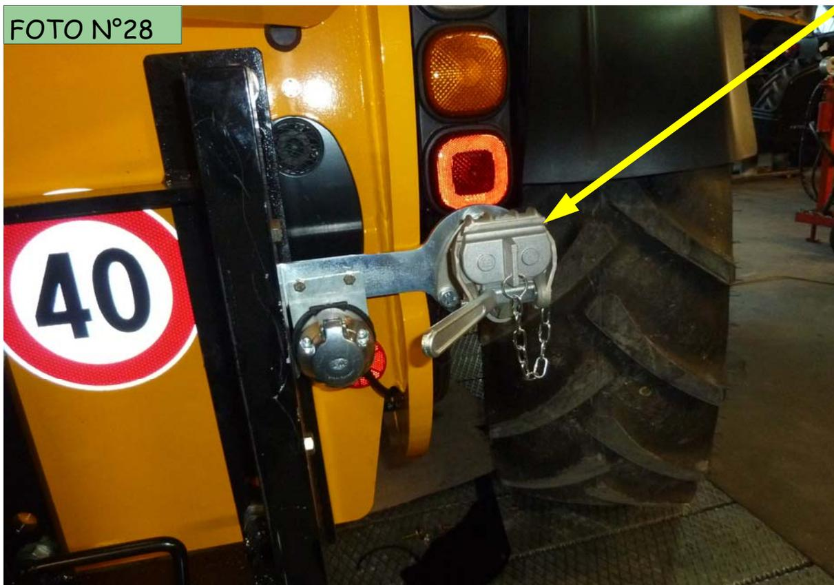
VISTA POSIZIONAMENTO GIUNTO CUNA SUL LATO " DX " POSTERIORE DELLA TRAT-TRICE. FISSARE IL GIUNTO CUNA AL SUPPORTO Cod. **DM600006-10** CON N°3 TE M10-X35 + DADO AUT. QUINDI FISSARE AL TELAIO SLIDER CON N°2 VITI TE M10X40+DADO
